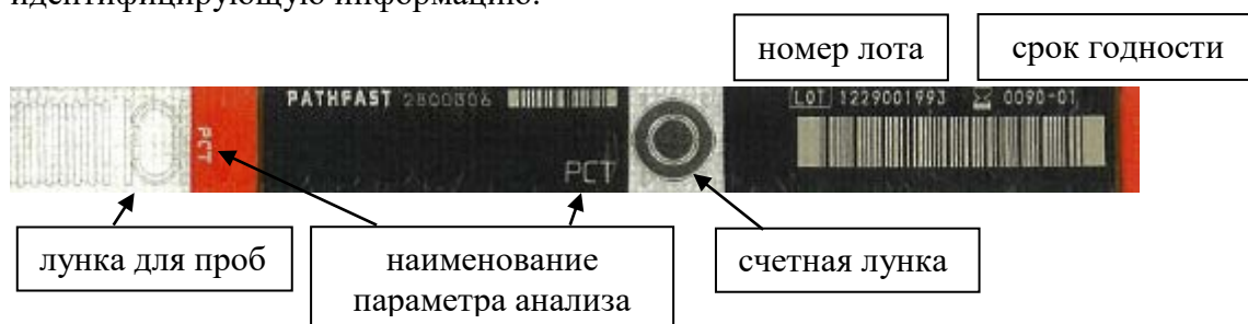
Рис. 1. Изображение картриджа с реагентами.
